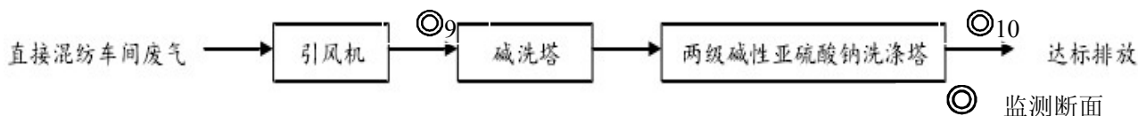
图 2.15 直接混纺车间废气处理工艺流程
